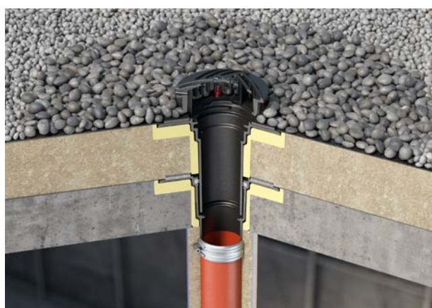
Wpust dachu płaskiego Spin z żeliwa z dwoma kołnierzami z przeciwkołnierzami do przykręcania izolacji
