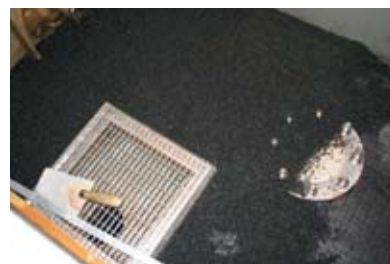
Zabudowa do próby z matą drenującą i podłożem ze żwiru łamanego przed osłoną wpustu dachowego
