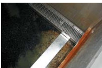
Zabudowa do próby z dostawionym elementem bocznym (bez wycięcia w korpusie kanału)
