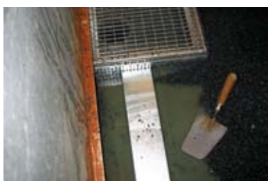
Zabudowa do próby z dostawionym elementem bocznym (bez wycięcia w osłonie wpustu dachowego)
