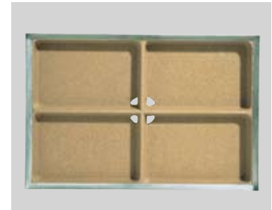
Podstawa wycieraczki ACO Vario® z polimerbetonu, z krawędzią ze stali ocynkowanej, żebrami wzmacniającymi i otworem odpływowym \varnothing 110
