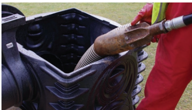
ACO Qmax® zdjęcia z demonstracji czyszczenia kanałów podczas testów przeprowadzonych przez ACO
