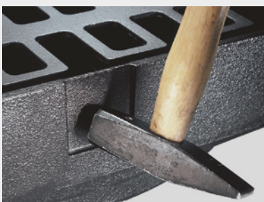
Rama rusztu przeznaczona do powierzchni utwardzonych wyposażona jest w specjalne wyżłobienia które można wybić aby odprowadzać wodę z nawierzchni podczas budowy. Wyżłobienia te zapewniają dużą powierzchnię wlotu ponieważ ruszt nie blokuje ich światła.
