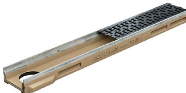
Kanał niski ACO Drain® Multiline V 100, 8 cm otworem Ø 110 i uszczelką
