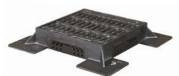
Pokrywa szczelinowa z ramą z żeliwa sferoidalnego w klasie obciążenia D400/F900
